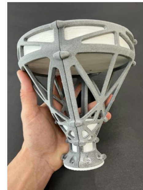
Primer prototipo de comprobación de la lente microondas en banda X.
